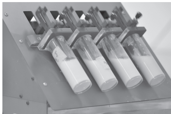
รูปที่ 2 การแปรงขึ้นตัวอย่างเรซินคอมโพสิตโดยสารละลายยาสีฟันเพื่อฟันขาวบนเครื่องแปรงอัตโนมัติ
