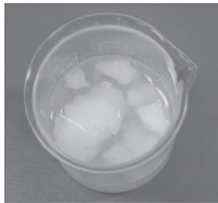
รูปที่ 2 แสดงโคพอลิเมอร์ของพอลิเมทิลเมทาคริเลตและพอลิสไตรีนที่สังเคราะห์ได้ก่อนที่จะทำให้แห้ง Fig. 2 shows the copolymer of polymethyl methacrylate and polystyrene before being dried.
