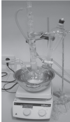
รูปที่ 1 แสดงเครื่องมือที่ใช้ในการสังเคราะห์โคพอลิเมอร์ Fig. 1 shows the apparatus used for copolymer synthesis.
