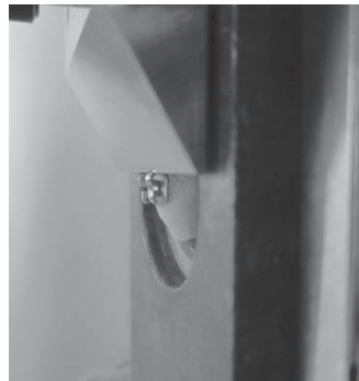
รูปที่ 2 แสดงการทดสอบชิ้นงานด้วยเครื่องทดสอบสากล แสดงทิศทางการบิดเคลื่อนลงในแนวเดียวกับแกนยาวของตัวฟัน
