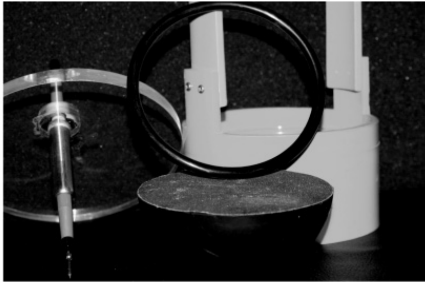
รูปที่ 6 ส่วนประกอบต่างๆ ของเครื่องสำรวจทางทันตกรรมสามารถแยกส่วนออกจากกันได้ Fig. 6 Parts of the dental surveyor are capable of disassembling from the mainframe structure.
