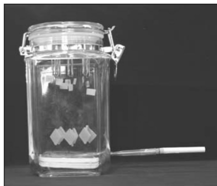
รูปที่ 4 ชิ้นงานที่แขวนและลอยอยู่ในกล่องอบควันบุหรี่
