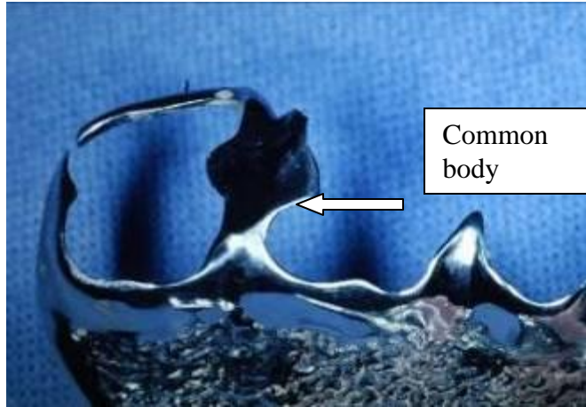
แสดงตะขอ ตะขอกู่ผ่านชอกฟัน ที่หักบริเวณ โคนตะขอ ซึ่ง #16 ปัญหานี้พบบ่อยเท่า ๆ กับการหักที่ Common body เมื่อกรอเตรียมส่วนชอกฟันด้านบดเคี้ยว (Occlusal embrasure) ไม่พอเพียง
