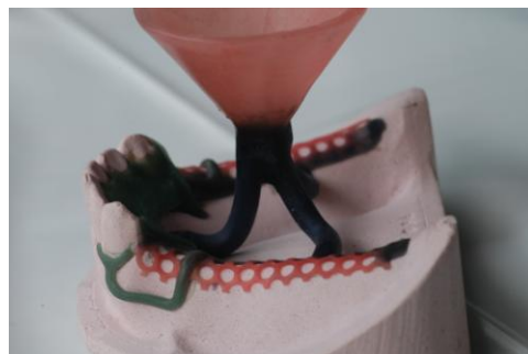
แท่งซี่ซี่หลักจะรวมกัน และเชื่อมต่อกับกรวยสปรู (sprue former)
